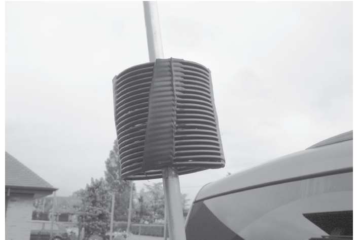
Fig. 3. Self pour 40 m à 21 spires, 4 mm de diamètre, Q \approx 300
